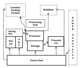
Fig. 1: Sensor Node-Components
